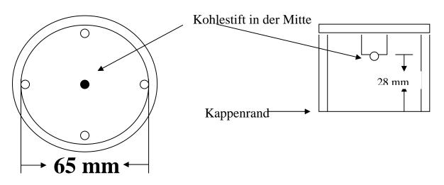
Innendurchmesser oder = Außendurchmesser Verteilergehäuse
